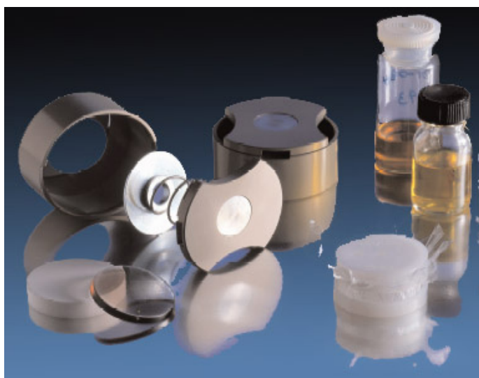
شکل ۲. کاست های استوانه ای برای نگهداری نمونه های روغنی و مایع در طول آنالیز طراحی شده اند.
