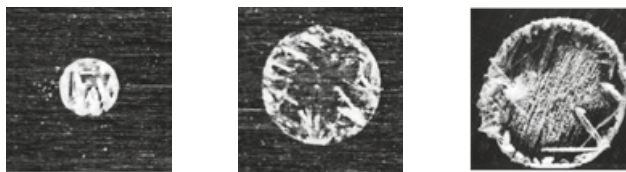
بسته به نوع نمونه، می توان تارگت AnchorChip با قطر بزرگتر یا کوچکتر انتخاب کرد. مثال های بالا تبلور DHB را به یک تارگت AnchorChip استاندارد از جنس فولاد ضد زنگ، با قطرهای ۸۰۰ میکرومتر و ۲۰۰۰ میکرومتر (از چپ به راست) نشان می دهند.
