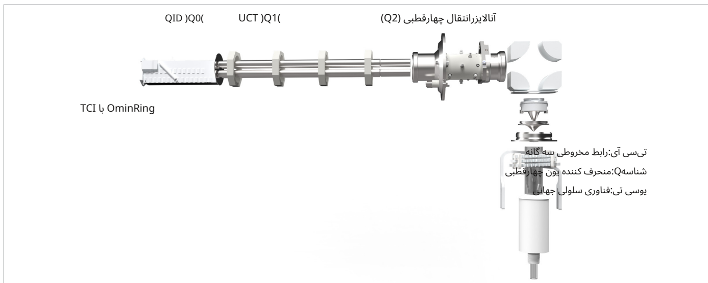
شکل ۸. اپتیک یونی NexION 2200 ICP-MS با سه چهارقطبی که به ترتیب با Q1، Q0 و Q2 مشخص شده اند.
