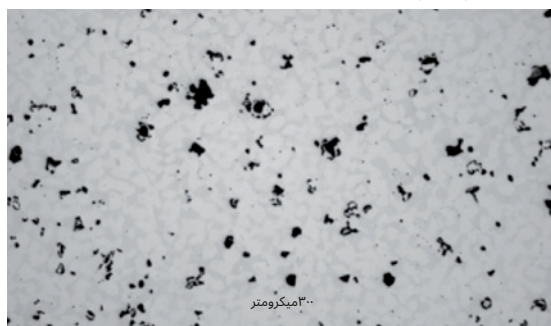
ساختار فلز پس از عملیات حرارتی، منجر به انبساط منافذ به دلیل انبساط گاز آرگون، محتوای آرگون: ۱۶۱۷۷ نانوگرم بر گرم
