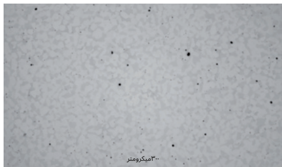
سازه‌فلزی بدون عملیات حرارتی، محتوای آرگون: ۱۶۱۷۷ نانوگرم بر گرم
