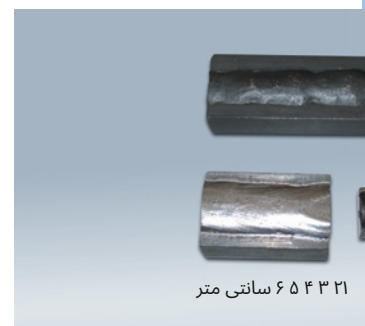
نمونه های جوشکاری فولاد معمولی، آماده سازی نمونه مطابق با استاندارد ISO 3690
