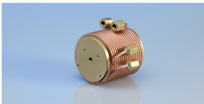
دوکاناله با مبدل حرارتی یکپارچه برای دمای یکسان گازهای مرجع و آنالیز TCD
