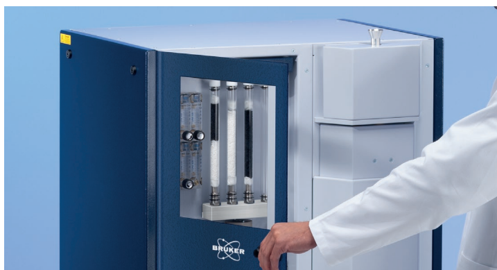
لوله های معرف بسیار بلند و با راندمان بالا برای استفاده کارآمد از معرف ها. همه معرف ها در قسمت جلو و پشت درب قرار گرفته اند تا عملیات سریع، راحت و ایمن انجام شود.
