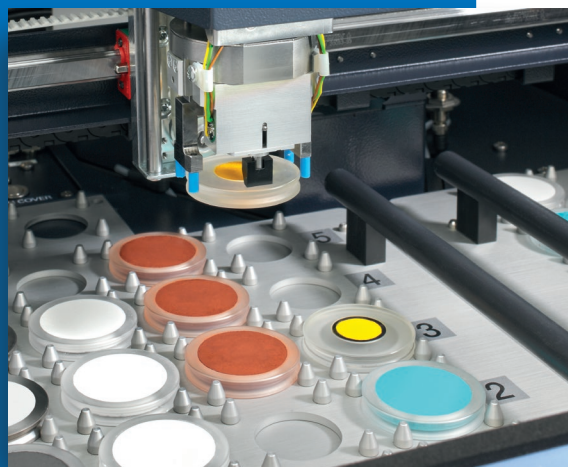
سینی بارگیری با گیره مکانیکی
