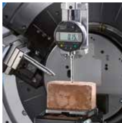
نشانه عقربه ای برای تراز ارتفاع نمونه
