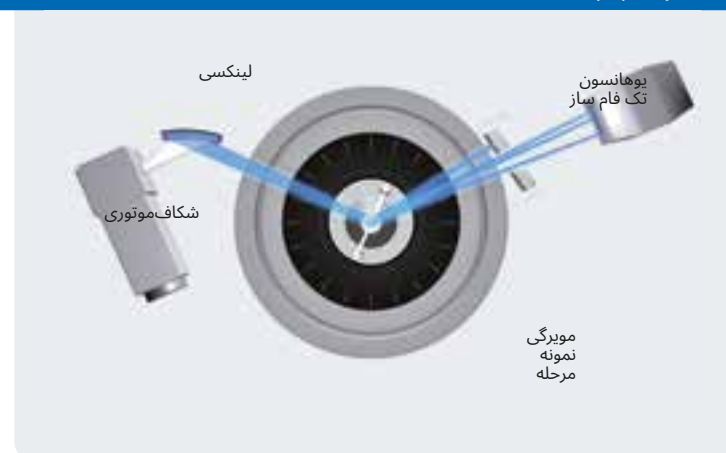
هندسه مویرگی با مونوکروماتور جوهانسون برای تابش خالص Ka1 و آشکارساز LYNXEYE
