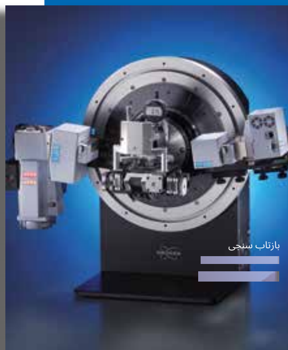
تنظیمات بازتاب سنجی TRIO/TWIN با آشکارساز LYNXEYE XE-T در حالت ۹۰ درجه
