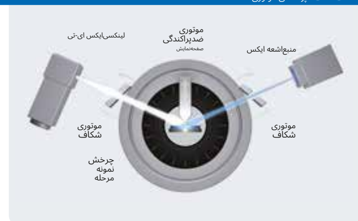
هندسه براگ-برنتانو با آشکارساز LYNXEYE XE-T با پراکندگی انرژی و صفحه ضد پراکندگی موتوری
