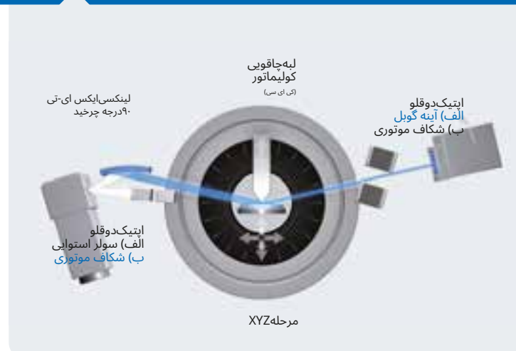
بازتاب سنجی TWIN/TWIN با آشکارساز XE-T LYNXEYE در حالت ۹۰ درجه
