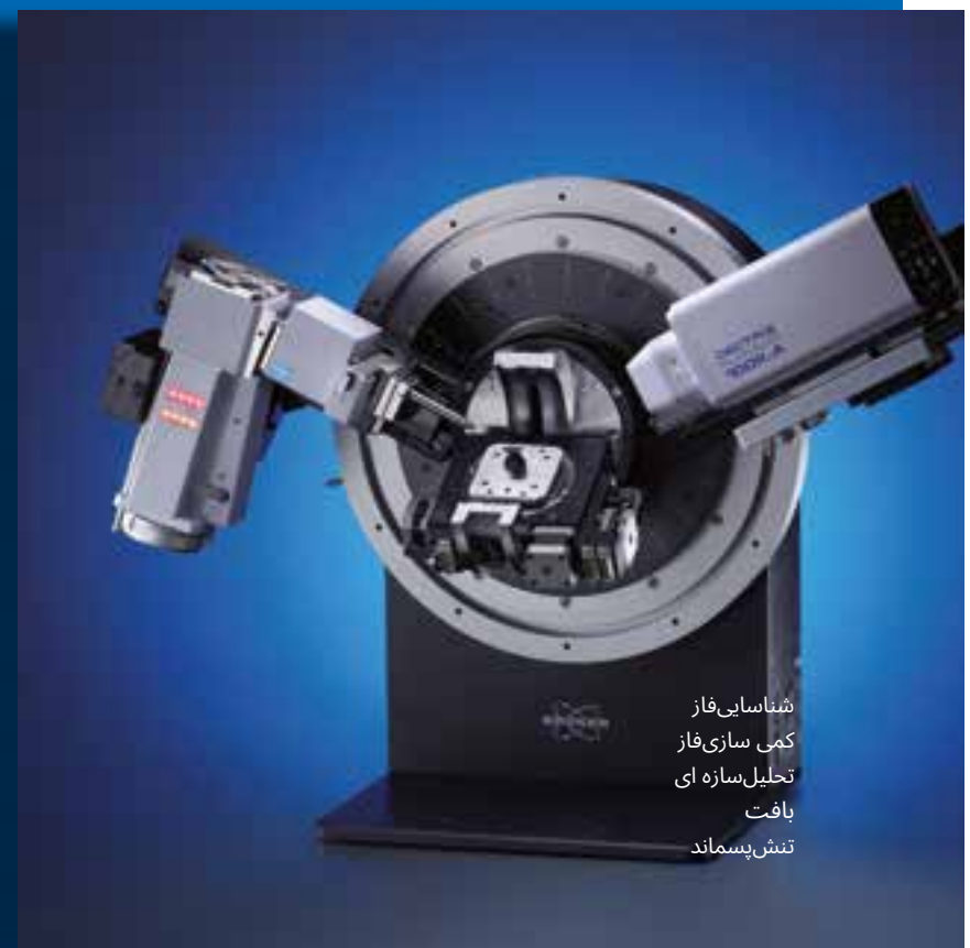
اندازه گیری تنش در حالت شیب جانبی (psi) با استفاده از PILATUS3 R 100K-A
