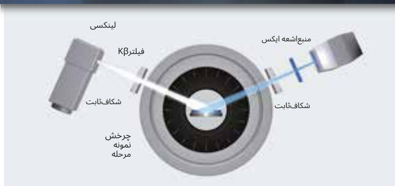
هندسه براگ-پرتانو با آشکارساز LYNXEYE
