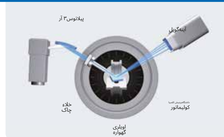
اندازه گیری تنش در حالت شیب جانبی (psi) با استفاده از PILATUS3 R 100K-A
