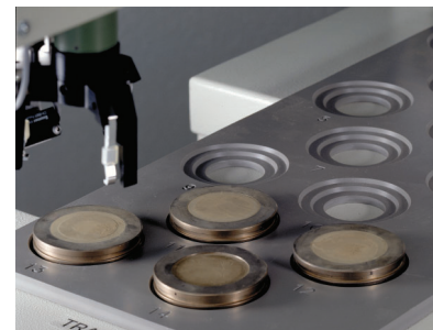
بارگذاری نمونه گلوله با استفاده از گریپر (نسخه ARL 9900 XRF)
