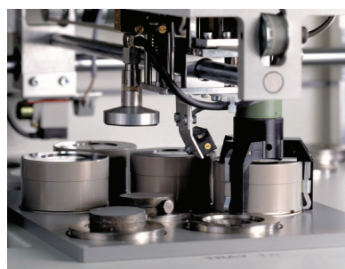
بارگذاری کاست برای آنالیز با استفاده از گریپر (نسخه ARL 9900 XRF)
