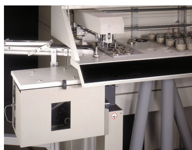
برچسب گذاری خودکار نمونه فلزی در پشت آن قبل از آنالیز (نسخه ARL 9900 XRF)
