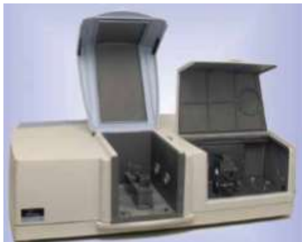
اسپکترومتر UV-Vis مدل LAMBDA 750s
