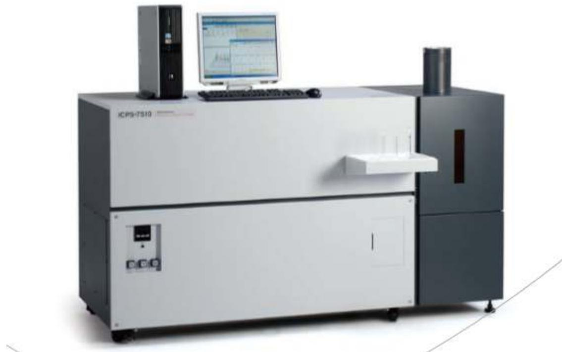
اسپکتروفتوومتر پلاسما جفت شده القایی ICP مدل ICPS-7510 با دو منوکروماتور متواالی، محصول شرکت Shimadzu کشور ژاپن می باشد . اسپکتروفتوومتر کوپل شده القایی ICP مدل ICPS-7510 ، می تواند برای حیطه وسیعی از آنالیز ارزیابی برای تحقیق و توسعه و مدیریت محیط زیست مورد استفاده قرار گیرد . اسپکتروفتوومتر پلاسما کوپل شده القایی ICP مدل ICPS-7510 گستره وسیعی از آنالیز عناصر را با استفاده از یک طیف سنج انتشار با پلاسما، به صورت نامحدود را مورد مطالعه قرار می دهد .
