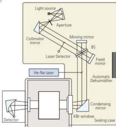
اسپکترومتر FTIR مدل FTIR-100 از یک رطوبت زدا اتوماتیک الکترونیکی بهره می برد که رطوبت را از داخل تداخل سنج با استفاده از یک غشا الکتروولیتی پلیمری جامد حذف می کند.
