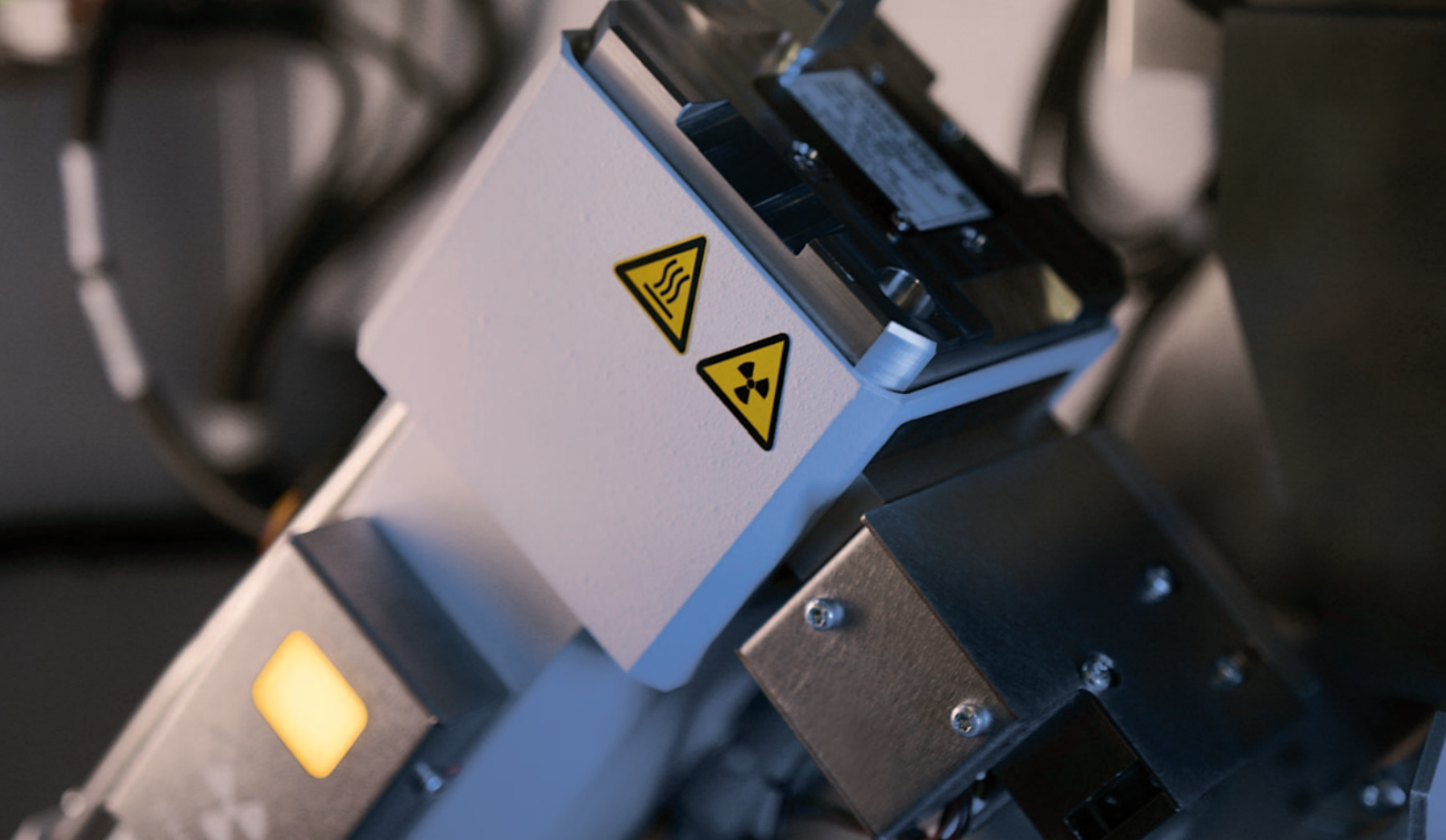
گزینه های توان منبع اشعه ایکس: ۵۴۰ وات، ۶۰۰ وات یا ۱.۲ کیلووات
