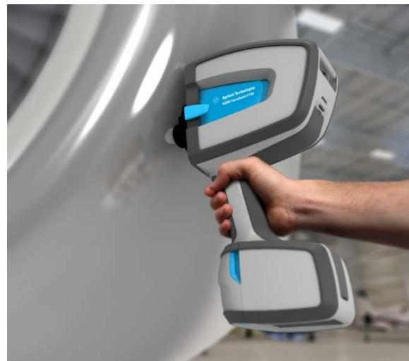
هر رابط نمونه برداری در اسپکتروسکوپی FT-IR پرتابل مدل 4300 برای دست یابی به حداکثر بازدهی بدون نیاز به ترازویندی اضافی مورد استفاده قرار می گیرد. همچنین طیف سنج FT-IR پرتابل مدل 4300 با استفاده از چیپس RFID می تواند به سرعت تشخیص دهد که چه رابط نمونه برداری به ابزار متصل شده است.
