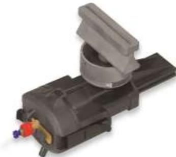
بدون خطوط گاز اتصال، اسپکتروفوتومتر جذب اتمی PinAAcle900Z مدل AAS مجهز به سوزن را می توان به راحتی بدون نیاز به ابزار برای تمیز کردن ساده و تغییر آسان بین تکنیک های تحلیلی حذف کرد .
