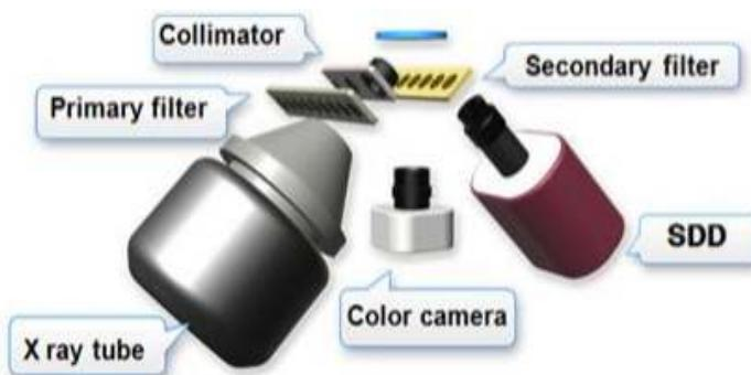
تجزیه و تحلیل حساسیت در کل محدوده انرژی، تجزیه و تحلیل حساسیت بالا را می‌توان در کل محدوده انرژی با استفاده از حداقل 9 نوع فیلتر و واحد خلاء محفظه نمونه انجام داد. \* Cl, Cu, Pb, Mo, Sb, Cd, In آپشن ها هستند.
