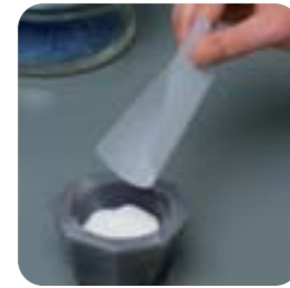
■ Pour flux melting agent into mortar
