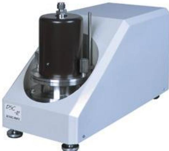
دستگاه گرماسنج روبشی تفاضلی DSC مدل DSC-RS یکی از پر کاربرد ترین دستگاه های گرماسنجی ساخت شرکت ADVANCE RIKO در کشور ژاپن می باشد.
